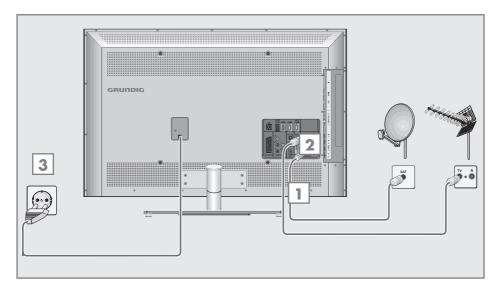
Zum Empfang digitaler Satellitenprogramme (DVB-S) das Kabel der Satellitenantenne an die Antennenbuchse »SATELLITE« am Fernsehgerät anschließen.
